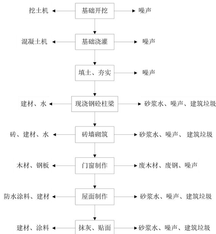
图 1 施工流程图
