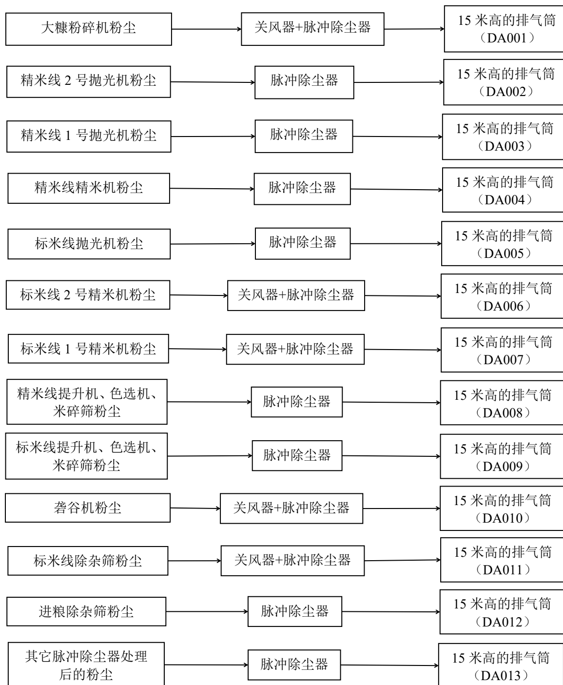
图 3.1-1 本项目废气处理工艺流程图
