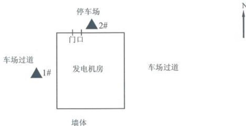
图 8-1 发电机监测点位图
