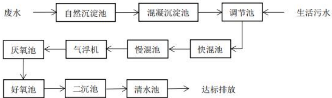
图 3-2 原项目综合废水处理系统
