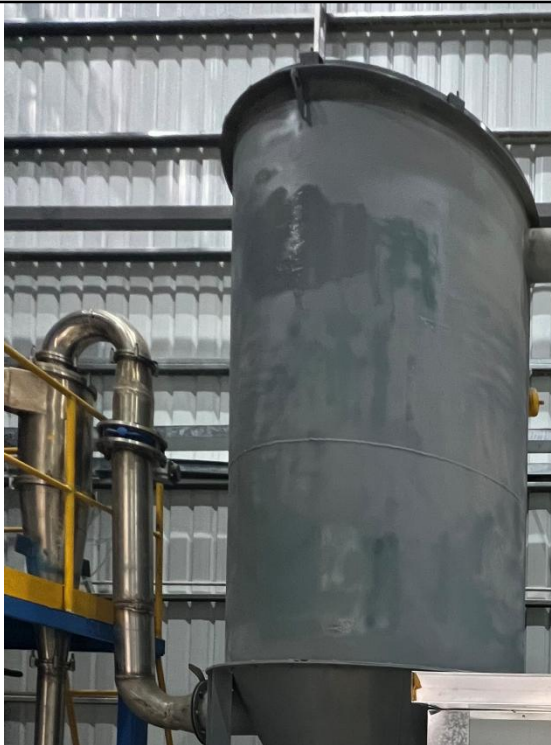
图 11 多级除尘器密闭管道示意图
