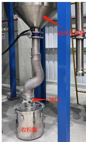
图 5 收粉罐与气流旋风分离系统接出口示意图
