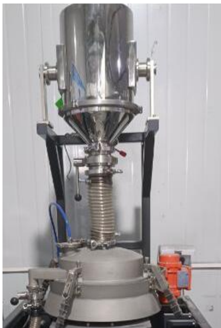
图 6 收粉罐与超声振动筛分机接入口示意图
